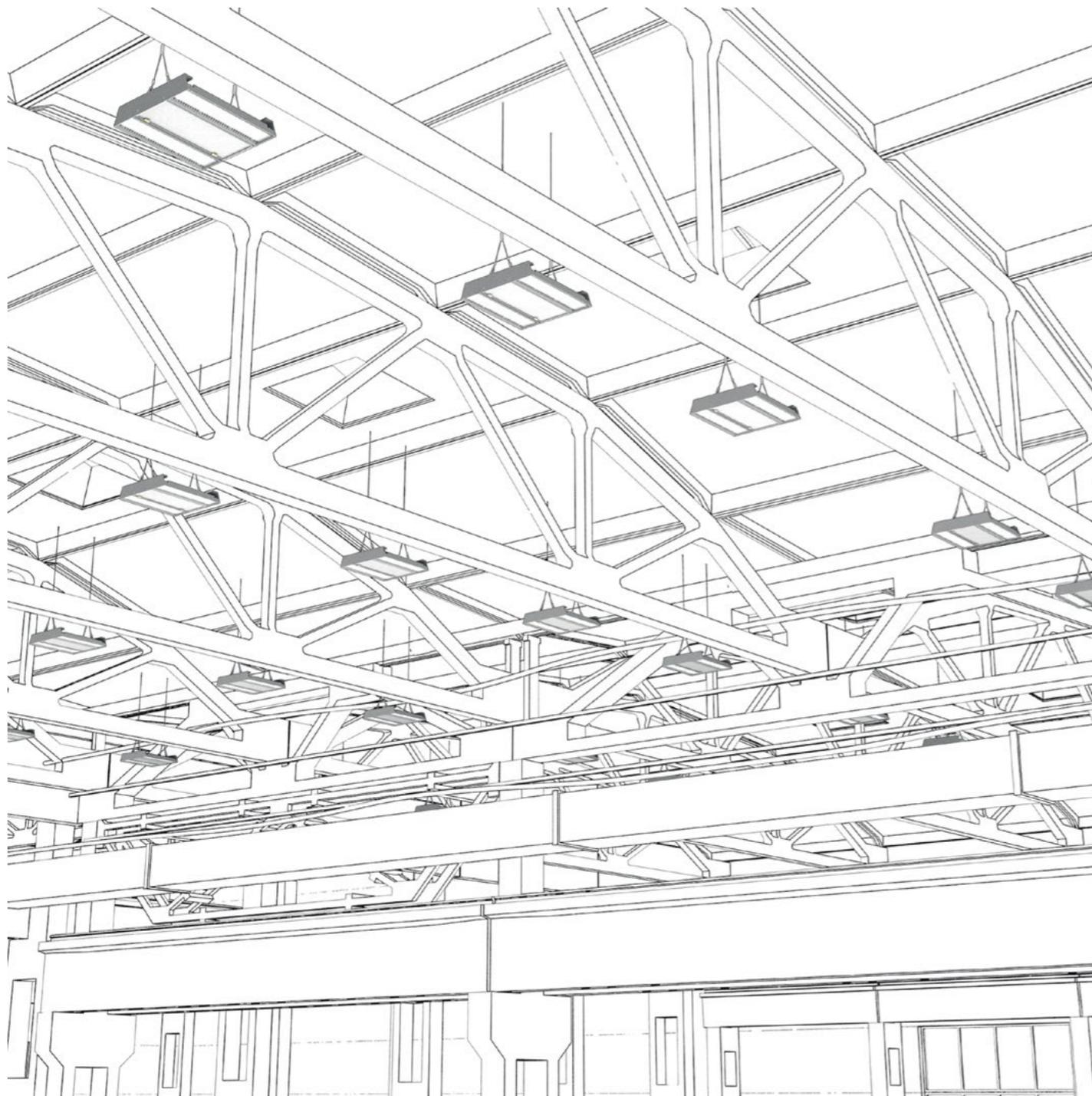
**REGINA**, это светодиодный светильник высокой эффективности от 140lm/W. Оптимальный светильник для общего освещения промышленных и складских помещений с высокими потолками.
